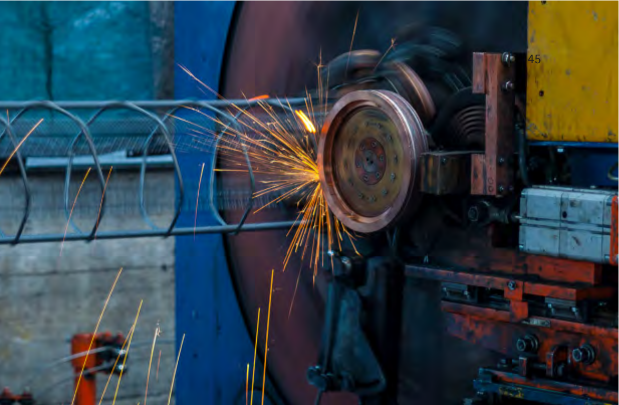
Automatisierte Herstellung von Stahlkörben
