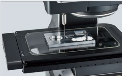
Der Messtaster erkennt und misst jedes Mal die gleiche Position
