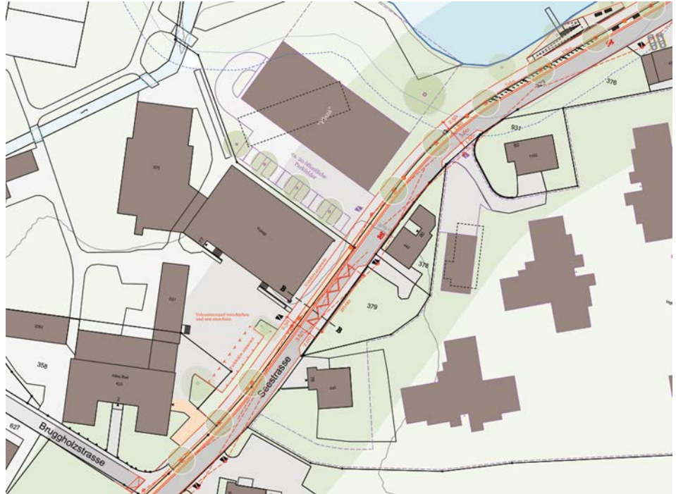
Abb. 28: Auszug BGK «Seestrasse», Begegnungsfall Lastwagen-Personenwagen bei 30 km/h möglich, dat. 30. September 2021; Quelle: KOLLEKTIV NORDOST, Steiner Wille Steiner Architekten AG, PLANE RAUM.
